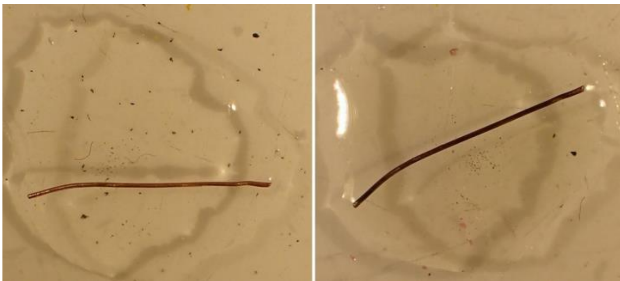
Esquerra: Fil de coure en àcid clorhídric (HCl). Dreta: Fil de coure ennegrit en dissolució d'eritrina en àcid clorhídric (HCl).
