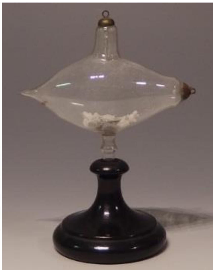
Figura 1. Tub de raigs catòdics antic on es podia observar la catodoluminescència. Les mostres de minerals emetien llum quan es connectaven els dos elèctrodes a una font d'alta tensió.
