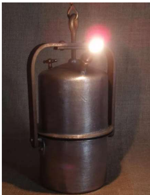
Foto 5: làmpada de carbur emprada en ambients miners.
