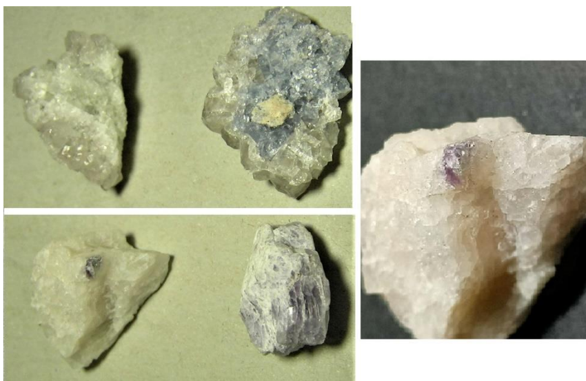
Fig. 3- Fluorita blava i violeta de la mina "Matagalls" al cap de deu dies d'exposició al sol. A dalt a l'esquerra, mostra exposada de fluorita blava comparada amb un fragment de la mateixa mostra sense exposar. S'observa una pèrdua total del color. A baix a l'esquerra, mostra exposada de fluorita violeta comparada amb un fragment de la mateixa mostra sense exposar. S'observa una pèrdua total del color excepte en un punt molt concret de la mostra, que conserva el color. A la dreta, detall de la petita zona que conserva el color i que va perdurar al llarg de quatre mesos per després desaparèixer i agafar color blanc com la resta de mostra. Fotos fetes amb llum càlida (halògena).
