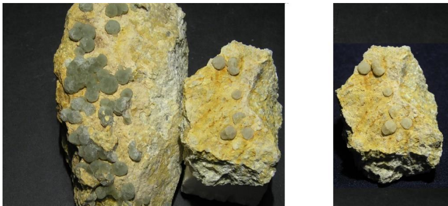
Fig. 6- Fluorita dels afloraments de Singuerlín. A l'esquerra fragment sense exposar a la llum del sol comparat amb la mostra exposada durant deu dies. A la dreta la mateixa mostra al cap de 365 dies. Fotografia feta amb llum càlida (halògena).
