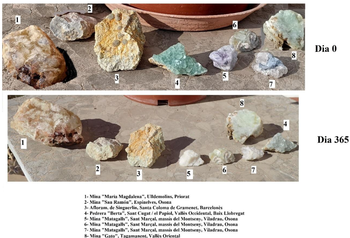
Fig. 1- Efecte de la llum solar sobre el color de mostres de fluorita de diversos jaciments catalans després de 365 dies d'exposició. Foto feta amb llum solar i amb unes condicions similars
